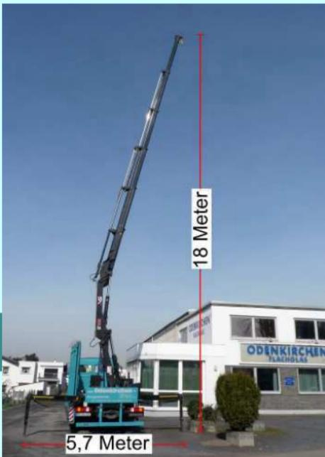
Wir verfügen für die Lieferungen über verschiedene Spezialtransporter, die zum großen Teil mit Krananlagen (bis 18 m Ausladung) zur einfachen Entladung vor Ort ausgerüstet sind.
