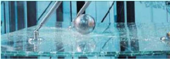
Für die Konstruktion einer Brüstungsverglasung sollte Verbundsicherheitsglas aus ESG (Einscheibensicherheitsglas) verwendet werden. Damit wird nicht nur eine höhere Stabilität der Scheibe erreicht, sondern auch das Verletzungsrisiko durch das Zerspringen der Glasfläche in Einzelkrümel minimiert. Auch für diesen Bereich können wir Ihnen viele verschiedene Beschlagsysteme zeigen, welche größtenteils eine Zulassung\* beinhalten.
